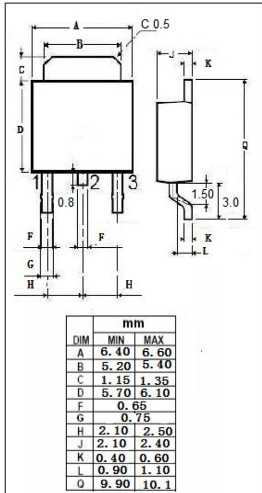
**isc Silicon NPN Power Transistor****2SC3518-Z****ELECTRICAL CHARACTERISTICS** $T_c=25^\circ\text{C}$  unless otherwise specified
